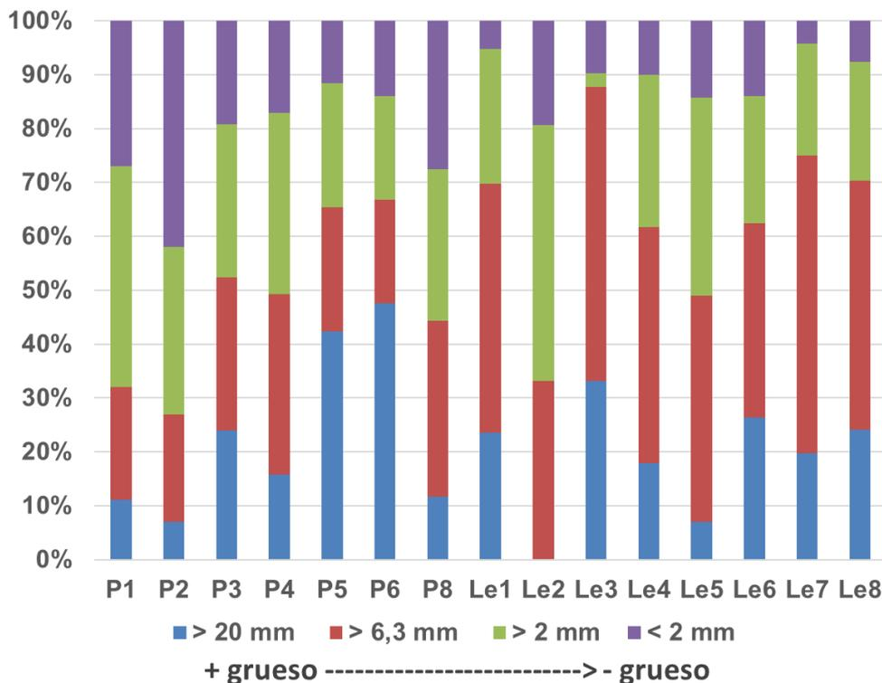
Figura 18. Caracterización granulométrica de las escombreras de carbón.
