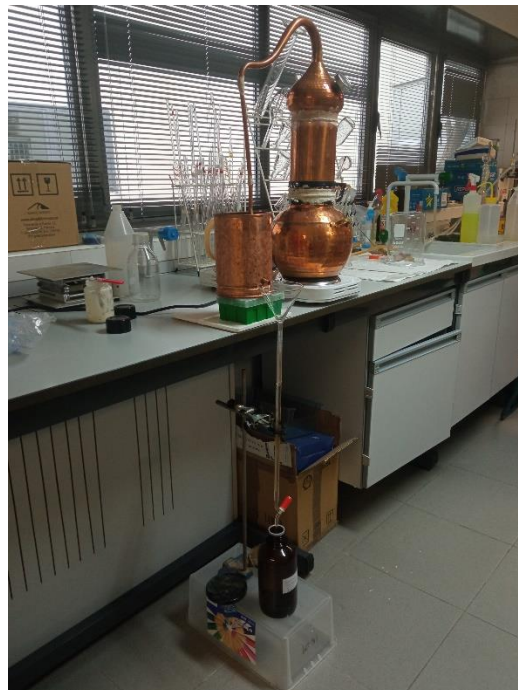
Figura de la izquierda: Equipo destilación en cobre. Figura de la derecha: Proceso de destilación y separación del hidrolato y aceite esencial.
